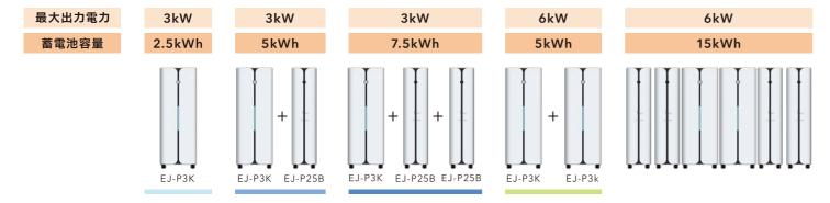
EJ-P3K 1台に増設バッテリーモジュール EJ-P25Bを2台まで追加することができます。この場合7.5kWhまで電池容量を増やせます。また、EJ-P3Kは2基連結することができ、出力電力も電池容量も2倍になります。最大構成は出力電力6kW、電池容量15kWhと定置型に匹敵します。
